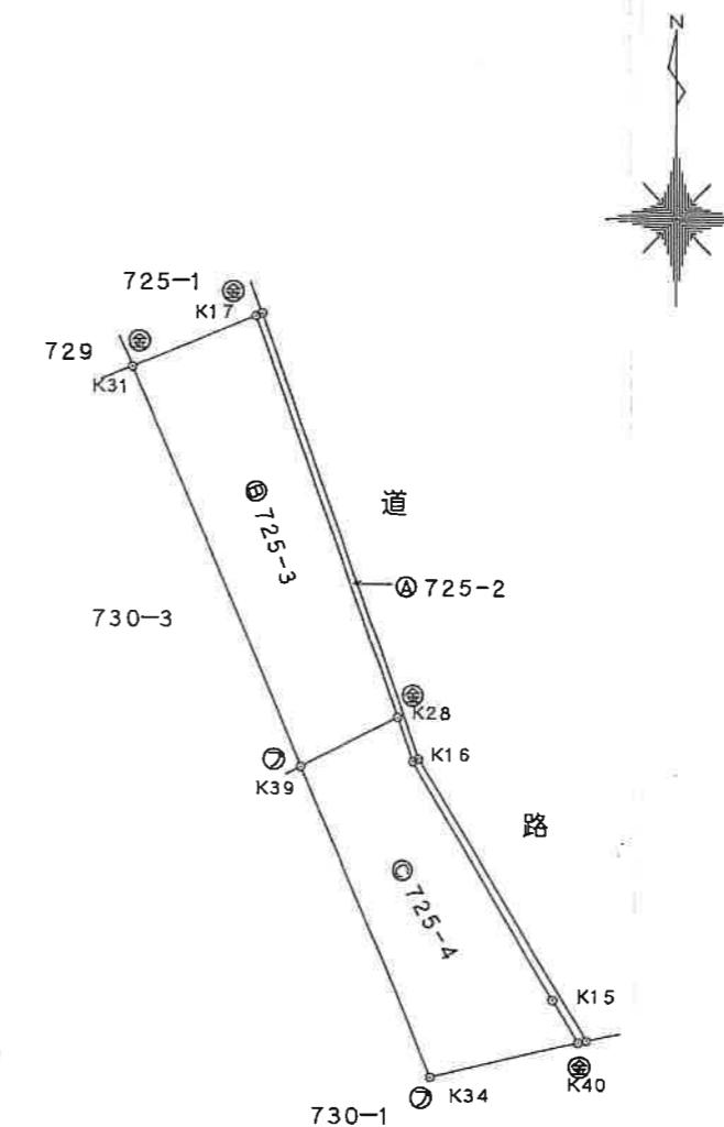
境界標略号 (石杭、プラスチック杭、コンクリート杭、金属標、刻印)
