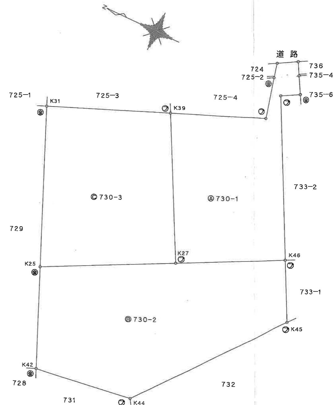
筆界標略号 ④…石杭、⑤…プラスチック杭、⑥…コンクリート杭、⑦…金属杭、⑧…鉄柱
